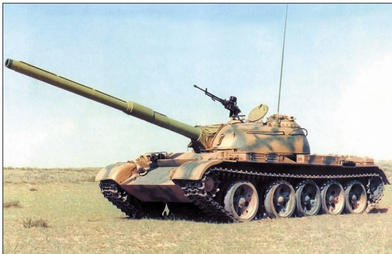
Танк Type 59Gai со 120-мм орудием
