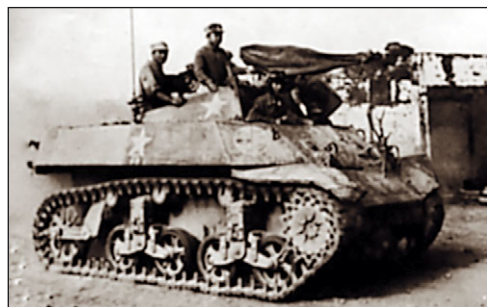
Некоторое количество "стюартов", сняв башни, китайцы превратили в разведывательные и командирские машины
