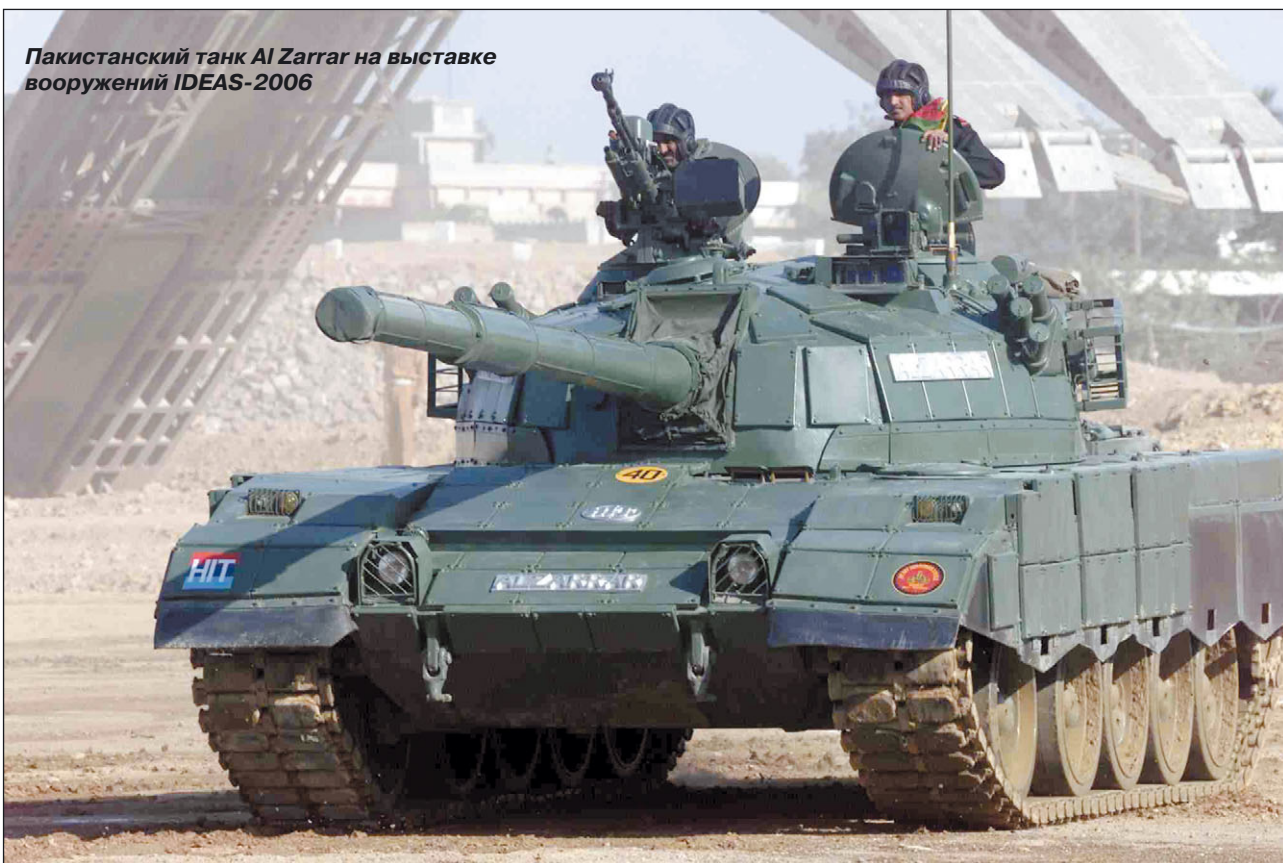
Туре 59D. Модули динамической защиты FY на лобовом листе корпуса
