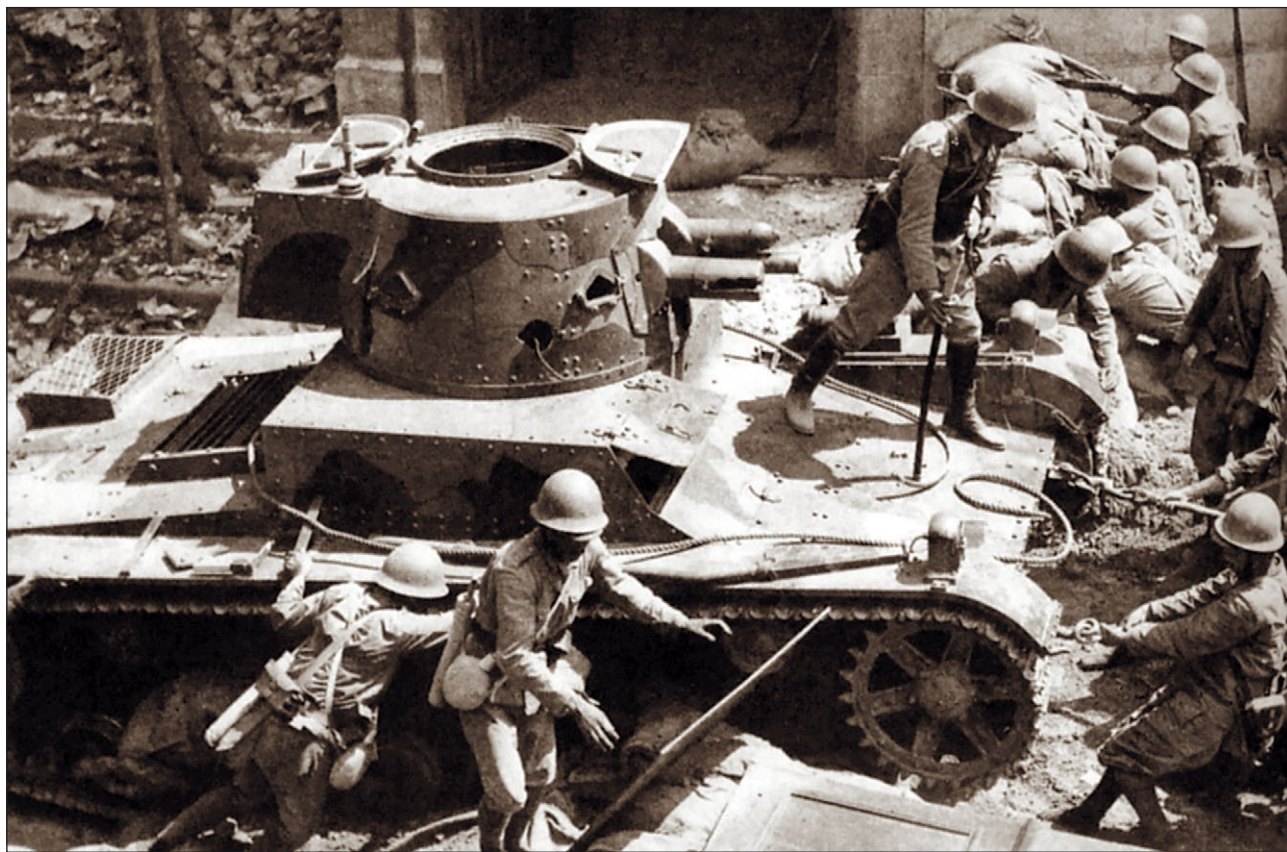
Японские солдаты под руководством офицера буксируют подбитый китайский Vickers Mk. E, 1937 год. Этот танк был оснащен радиостанцией, о чем свидетельствует ниша в корме башни, и нес четырехцветный камуфляж
