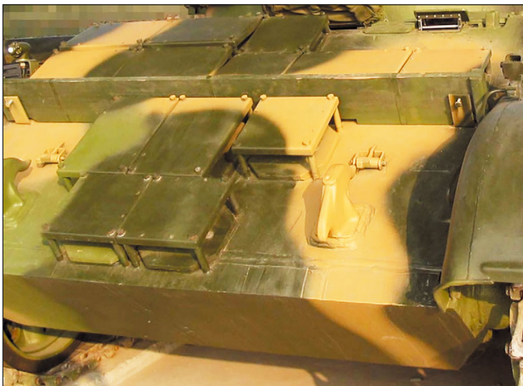
Туре 59D. Модули динамической защиты FY на лобовом листе корпуса
