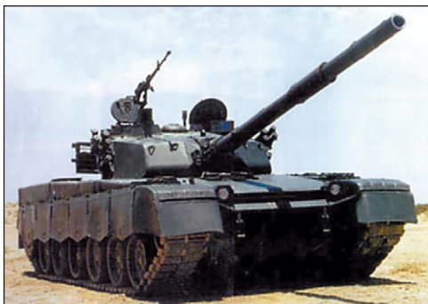
Прототип Type 90-II с двигателем MTU396
