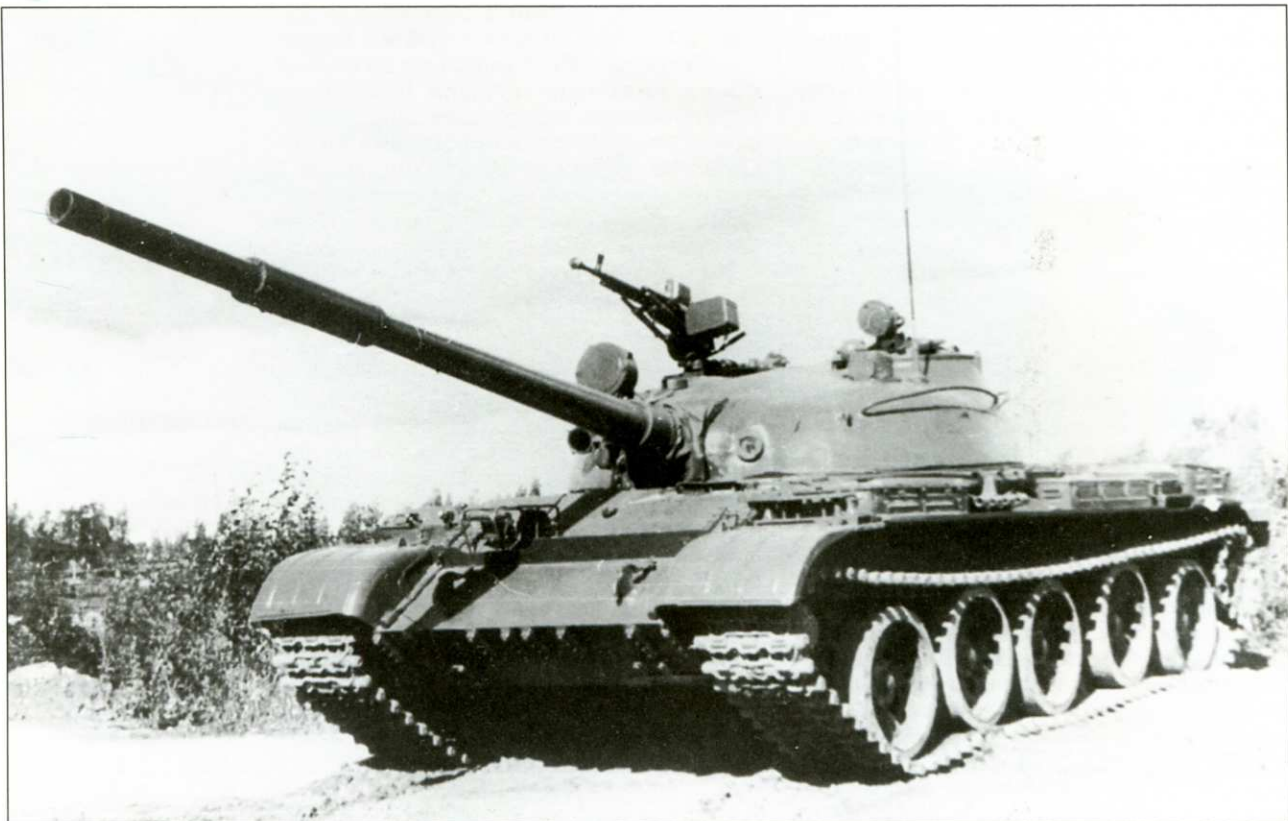
Танк Т-62 выпуска 1972 года. Главным отличием стала установка зенитного пулемета ДШКМ на люке заряжающего
