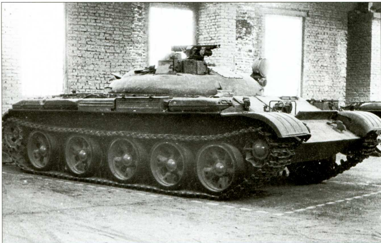
Ракетный танк ИТ-1 в музее Уралвагонзавода. Пусковая установка ракеты 3М7 находится в боевом положении
