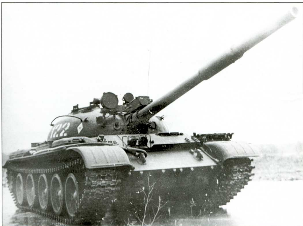
С 1975 года часть танков Т-62 была оснащена лазерным дальномером КДТ-1, устанавливавшимся над стволом пушки
