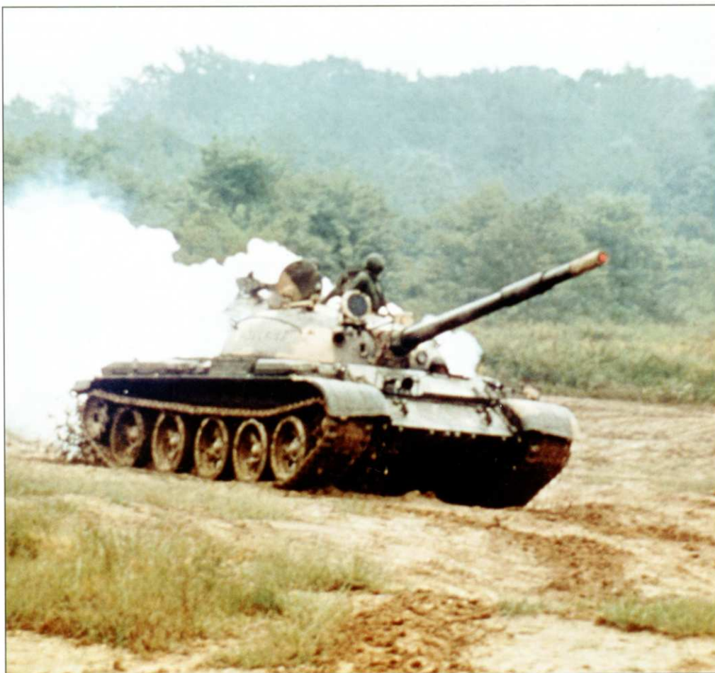
С л е в а : Танк Т-62 ставит дымовую завесу с помощью ТДА во время испытаний в США
