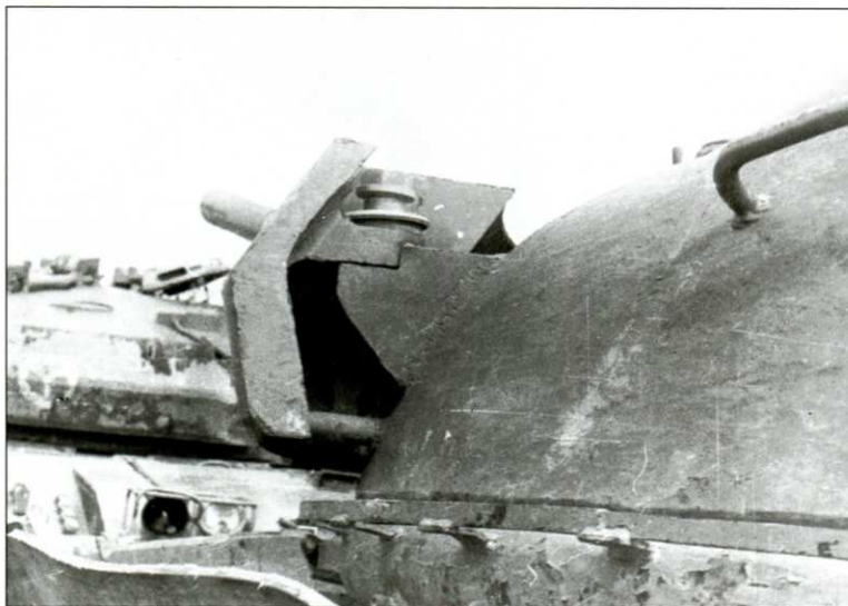
Узел крепления дополнительного бронирования («бровей») на башне
