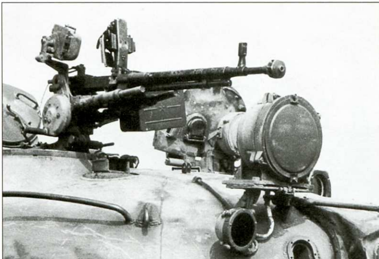
Зенитный пулемет ДШКМ, установленный на люке заряжающего танка Т-62
