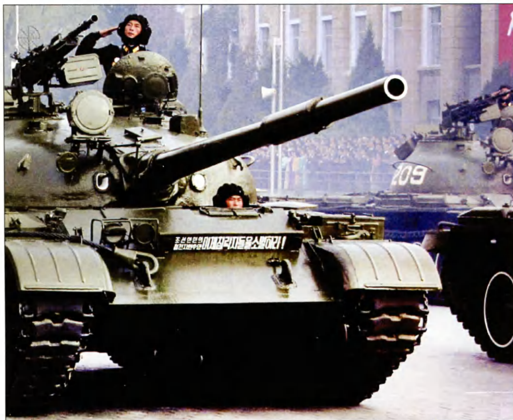
Танки Т-62 Корейской народной армии на параде в Пхеньяне. Штатные ЗПУ с пулеметами ДШКМ заменены на корейские установки с пулеметами КПВТ
