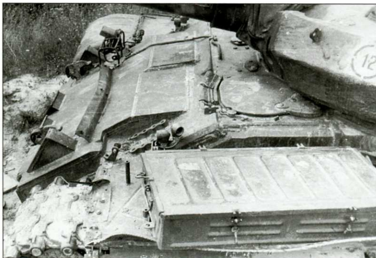
Накладная броня на верхнем лобовом листе корпуса
