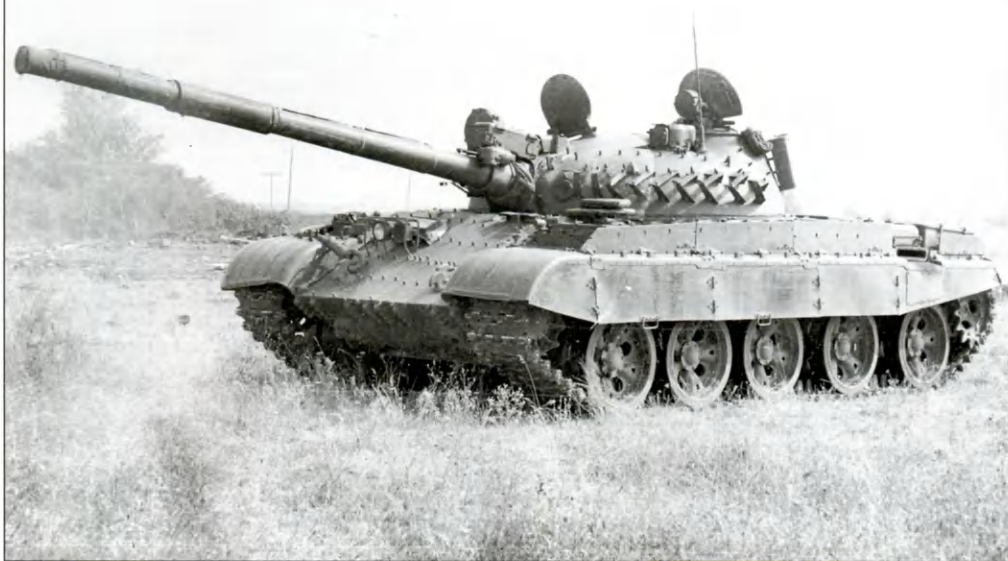
Слева: Средний танк Т-62МВ. На башне и корпусе хорошо видны бонки и крон- штейны для креп- ления элементов комплекса динами- ческой защиты
