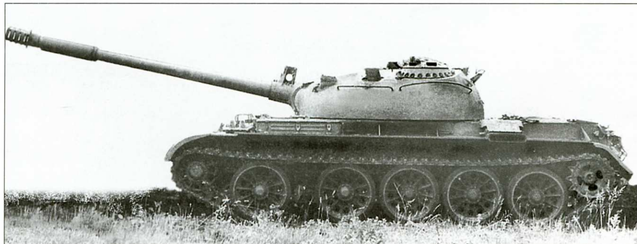
Опытный образец танка «объект 139» с пушкой Д-54ТС
