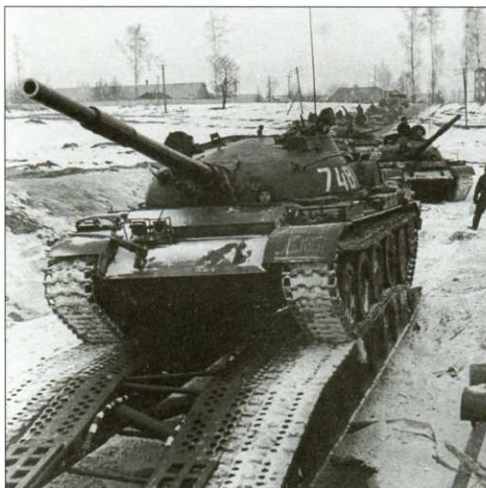
Танк Т-62 преодолевает препятствие по колежному мосту. Московский военный округ, январь 1973 года
