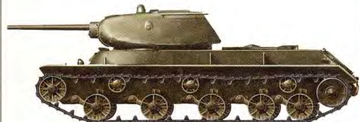
Опытный тяжелый танк ИС-1 с 76-мм гаубицей
