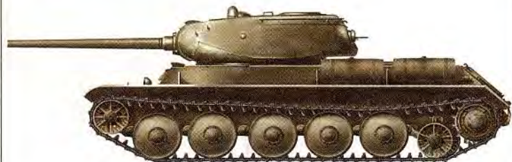
Опытный тяжелый танк ИС-1 с 85-мм гаубицей и добавленным шестым опорным катком
