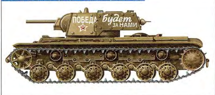
Тяжелый танк KB-1 образца 1939 г. со сварной башней
