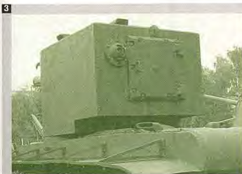
Тяжелый танк KB-2 с 152-мм гаубицей МЛ-20С
