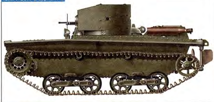
Танк Т-38Ш с пушкой ТНШ-20
