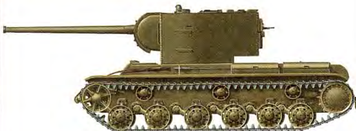
Тяжелый танк KB-2 с 152-мм гаубицей МЛ-20С
