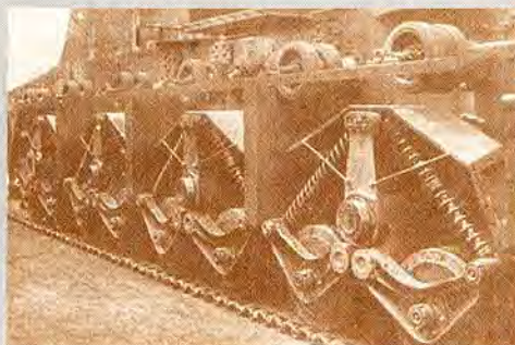
Ходовая часть танка увеличилась до восьми опорных катков (на борт), объединенных попарно в четыре тележки.
