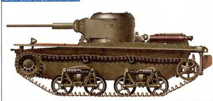
Танк Т-38Ш с пушкой ТНШ-20
