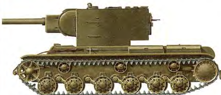
Тяжелый танк KB-2 с 152-мм гаубицей МЛ-20С
