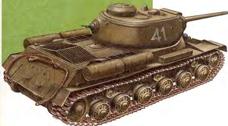
Опытный тяжелый танк ИС-1 с 122-мм гаубицей
