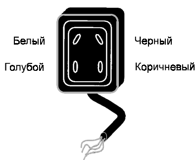
Рис. 8.7. Выводы дистанционного выключателя блока питания
