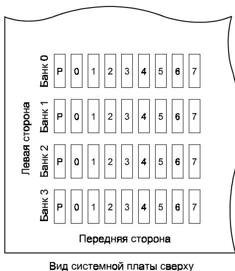
Рис. 7.19. Банки памяти на системных платах PC типа 2 и XT типа 1
