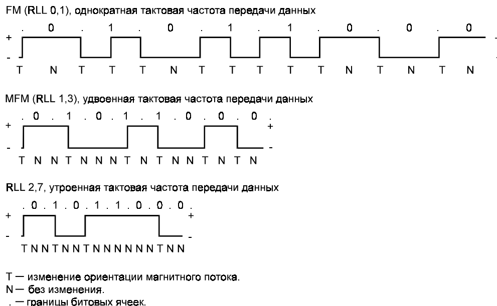
Рис. 14.2. Сигналы, формируемые во время записи ASCII-кода символа “X” при способах кодирования FM, MFM и RLL 2,7
