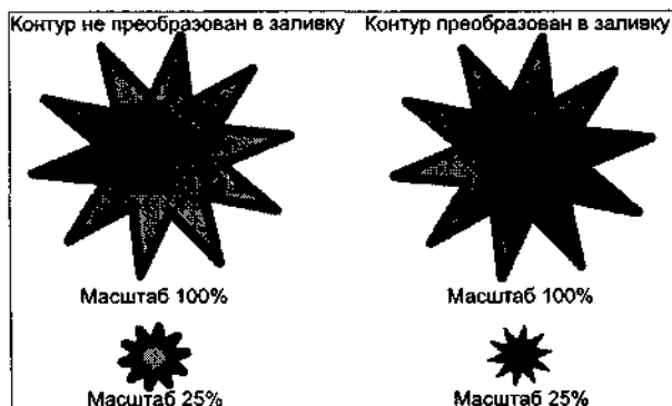
Рис. 7.15. Преобразование линий в заливки гарантирует пропорциональное изменение толщины всех элементов рисунка
