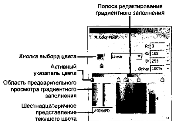
Рис. 5.8. Панель Color Mixer позволяет создавать собственные образцы градиентного заполнения
