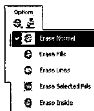
Рис. 4.19. Установки модификатора Eraser Mode позволяют ограничить "разрушительный эффект" применения инструмента Eraser
