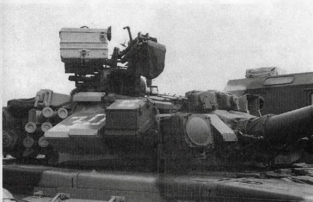
Башня Т-90 крупным планом. Над стволом пушки установлены приемные головки обнаружения лазерного излучения, а справа от пушки — правый осветитель системы оптико-электронного подавления «Штора-1»
