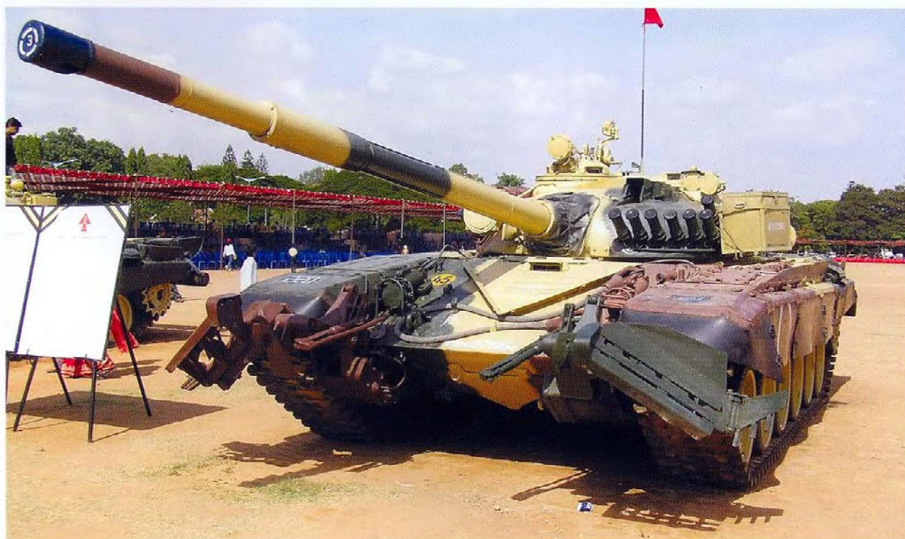
Танк Т-72М1 индийского производства. На машине установлен колеяный ножевой минный трал КМТ-6. Internet
