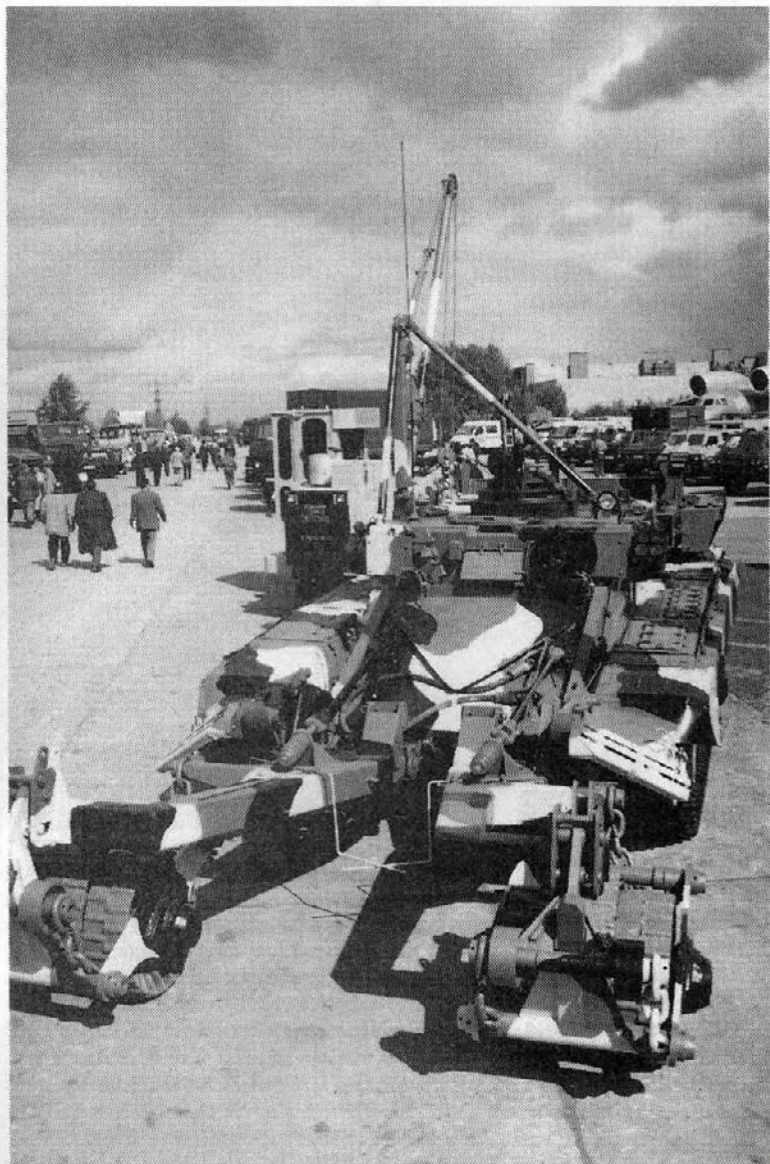
Боевая машина разминирования БМР-3 «КОРТ-Б» на выставке ВТТВ «Омск-99». Машина оборудована колейным минным тралом КМТ-7
