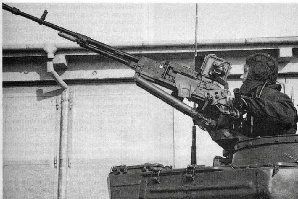
Установка зенитного пулемета НСВ-12,7 в боевом положении
