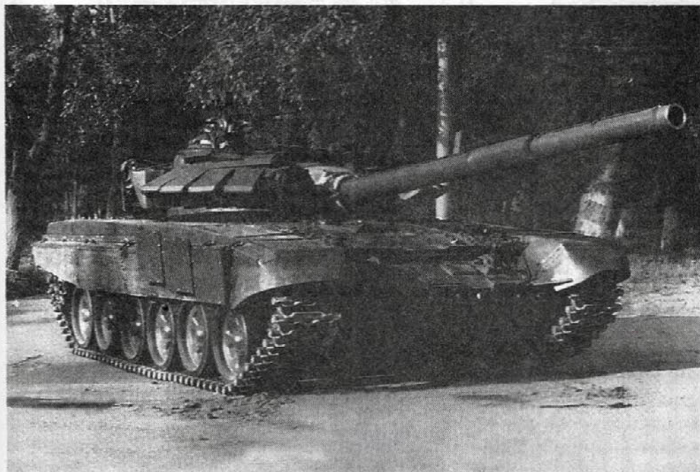
Танк Т-72БМ со встроенной дина- мической защитой. 1989 год
