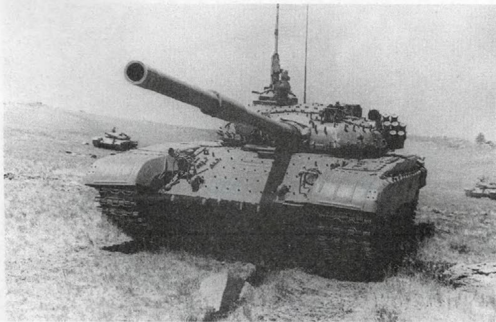
Т-72Б-1 на тактических занятиях. На машине установлены бонки для крепления блоков динамической защиты, но сами блоки не установлены. 1988 год
