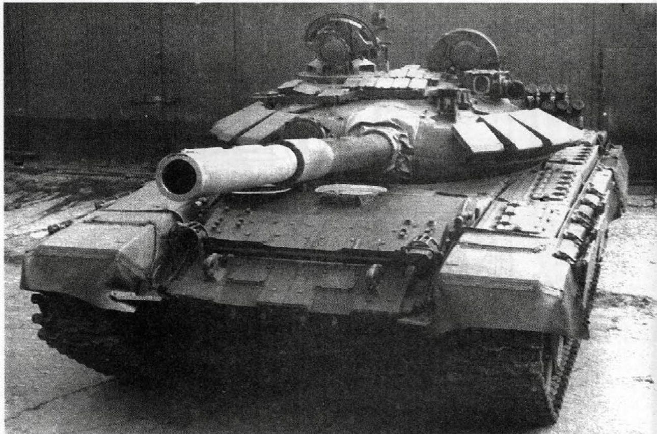
Танк Т-72БМ. Крышка амбразуры защитного кожуха прицела-прибора наведения 1К13 в боевом положении, то есть — открыта
