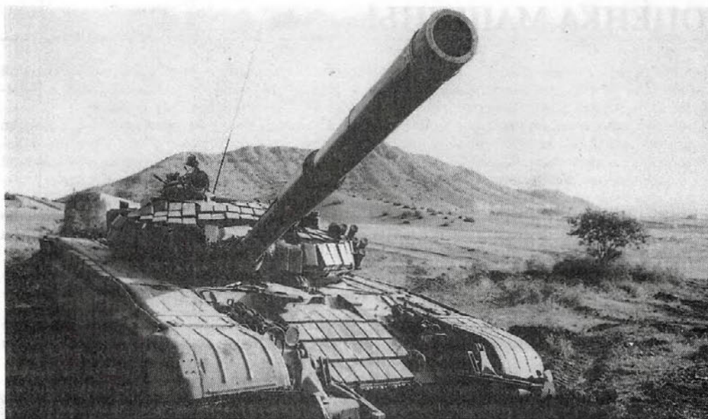
Танк Т-72Б азербайджанской армии на боевой позиции. Машина оборудована колейным ножевым минным тралом КМТ-6. Азербайджан, Агдамский район, май 1992 года
