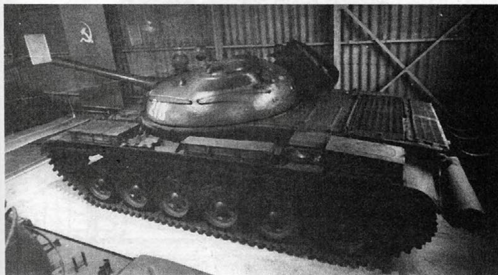
«Объект 167» в экспозиции танкового музея в Кубинке. Эта машина оснащена пусковой установкой ПТУР «Малютка» на башне
