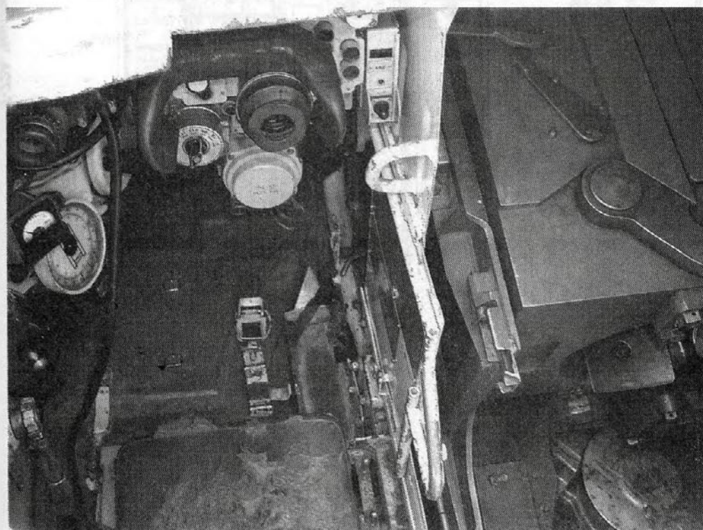
Внизу — Вид на рабочее место наводчика через его люк. Хорошо видны налобник и окуляр прицел-дальномера ТПД-К1
