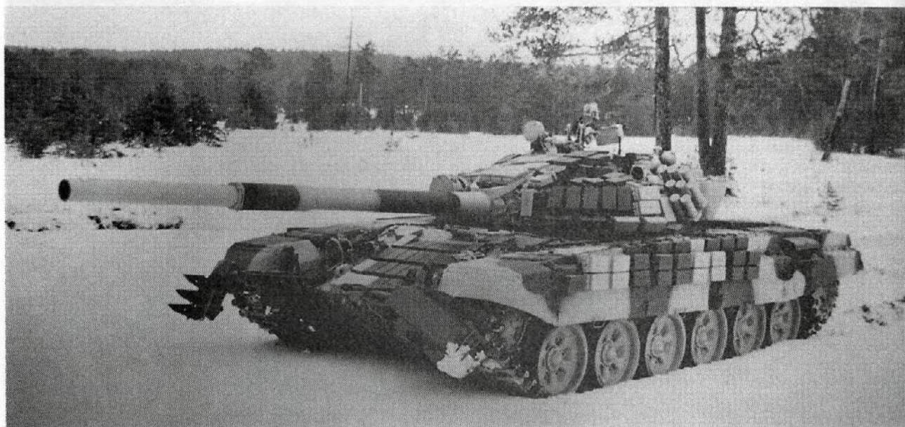
Танк Т-72С с колей- ным ножевым тралом КМТ-8
