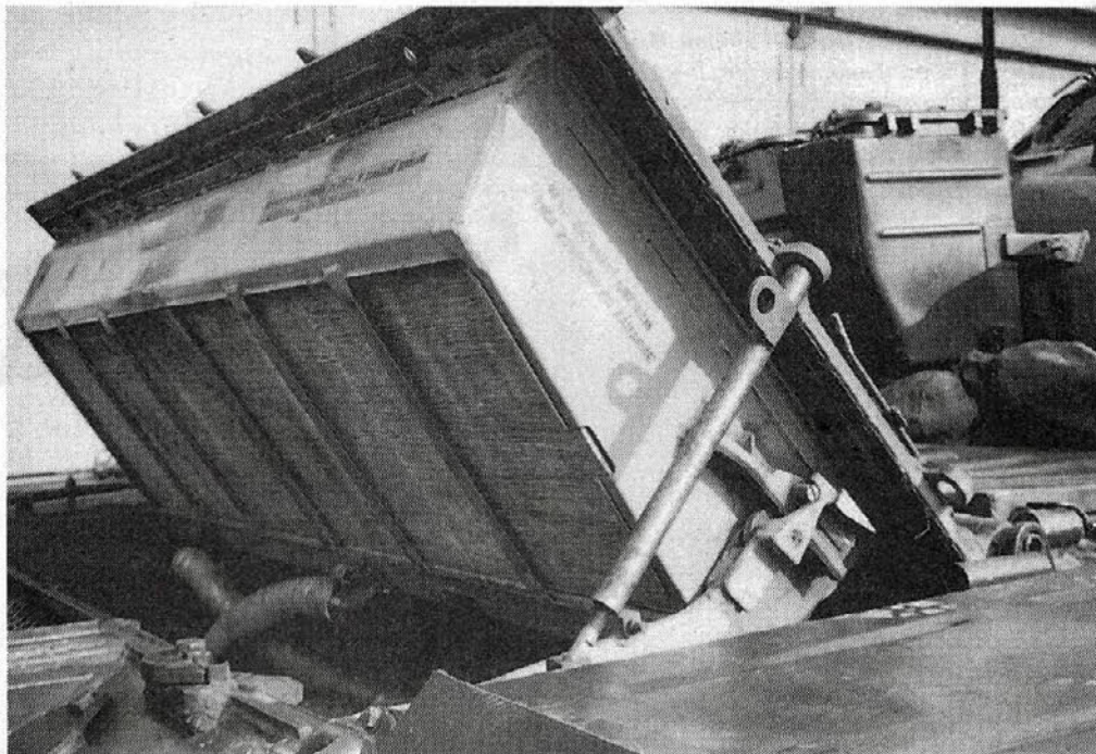
Крыша со стеллажом радиаторов в поднятом положении
