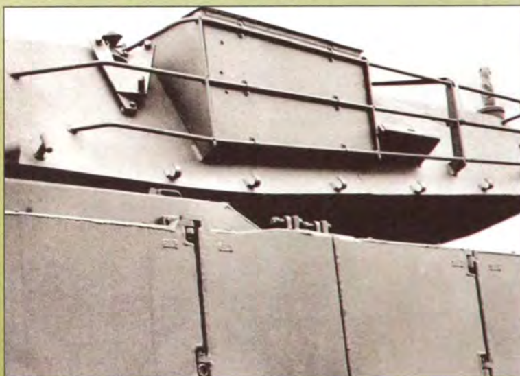
Ящик для снаряжения на левом борту башни. Перед ним — кронштейн крепления шестиствольного дымового гранатомета
