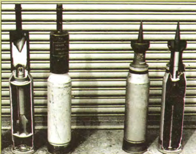
Рабочее место заряжающего танка М1А1 (вверху). Кумулятивный и бронебойно-подкалиберный выстрелы к 120-мм пушке (внизу)
