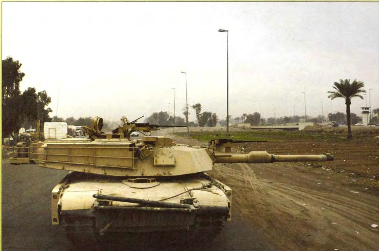
Танк M1A1, модернизированный по программе TUSK. Хорошо виден крупнокалиберный курсовой пулемет, установленный над стволом 120-мм пушки
