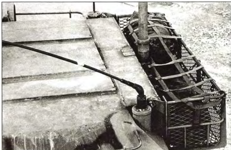
Вид на корзину для имущества танка IP M1. Сетка из ремней, предохраняющая предметы снаряжения и амуниции от выпадания из корзины при движении по пересеченной местности, изготовлена силами экипажа
