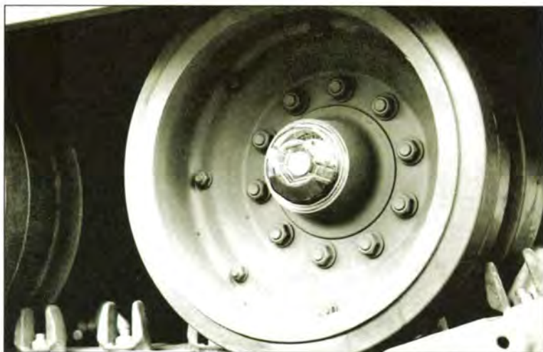
Опорный каток. Пластиковые втулки на осях балансиров облегчали обслуживание ходовой части
