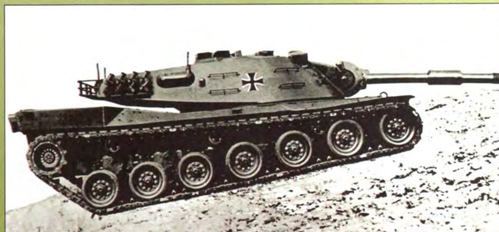
Первый американский прототип основного боевого танка MBT70 (вверху). Первый американский прототип с установленной 20-мм пушкой (в центре). Демонстрация первым западногерманским прототипом танка MBT70 возможностей подвески по изменению клиренса (внизу)
