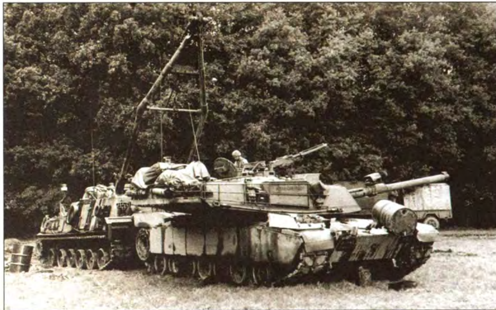
Замена силового блока на танке М1 Abrams занимала 1 ч. (слева и внизу)
