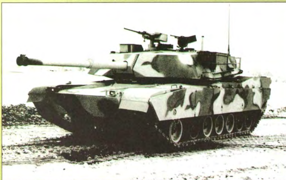
Опытный образец танка XM1 фирмы Chrysler с «гибридной» башней. Пилотный танк из первой партии в 11 машин, изготовленный в 1978 году
