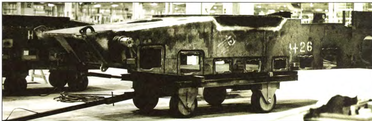
Корпус танка М1 в сборочном цеху
