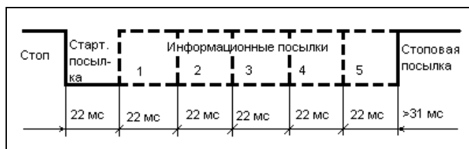
Рис. 2.2. Структура телетайпного сигнала
