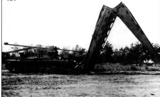
Английский танк-мостокладчик «Валентайн» (Valentine-Bridgelayer) проходит испытания на полигоне НИБТ Главного бронетанкового управления РККА. Кубинка, 1944г. A British Valentine - Bridgelayer undergoes testing at the NIBT Test Range of the Main Armored Vehicle Directorate of the RKKA. Kubinka, 1944.
