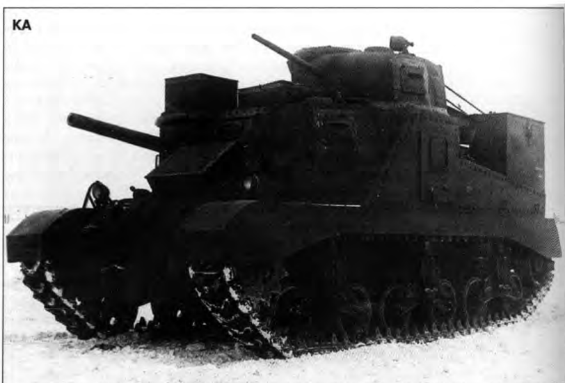
Ремонтно-эвакуационный танк M31 на базе M3 «Ли» на испытаниях в Кубинке. An M31 recovery vehicle based on the M3 Lee undergoes testing at Kubinka.
