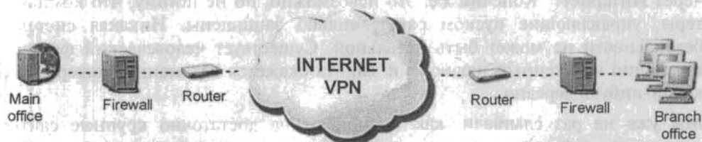
Рис. 5.12. Пример связи центрального офиса и филиала через VPN
